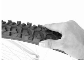
Contrôlez l'usure et la pression de gonflage des pneus. La bonne pression de gonflage est indiquée sur l'extérieur du pneumatique. **Pour indication : 14,5 PSI = 1 BAR et 1 BAR = 1Kg/cm2.** Remplacez les pneus et les chambres à air lorsqu'ils sont usés ou défectueux
