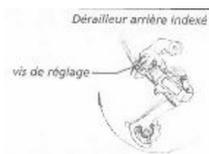
**Conseil :** Le dérailleur arrière doit permettre de changer aisément de vitesse. Pour obtenir le meilleur résultat possible, sans détérioration du mécanisme, il est recommandé de ne pas appuyer fortement sur les
