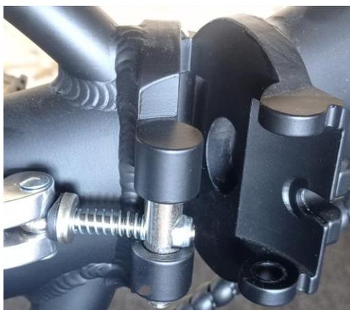
**ATTENZIONE:** i meccanismi di sgancio rapido sono progettati per essere azionati manualmente. Per evitare di danneggiare il meccanismo, non utilizzare mai attrezzi per bloccarlo o sbloccarlo. Per regolare la forza di serraggio, utilizzare il dado di regolazione situato di fronte alla leva e non ruotare la leva di sgancio rapido.
