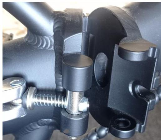
**AVERTISSEMENT:** Les mécanismes de déverrouillage rapide sont conçus pour être actionnés manuellement. Pour éviter d'endommager le mécanisme, n'utilisez jamais d'outils pour le verrouiller ou le déverrouiller. Pour régler la force de serrage, utilisez l'écrou de réglage situé devant le levier et ne tournez pas le levier de blocage rapide.
